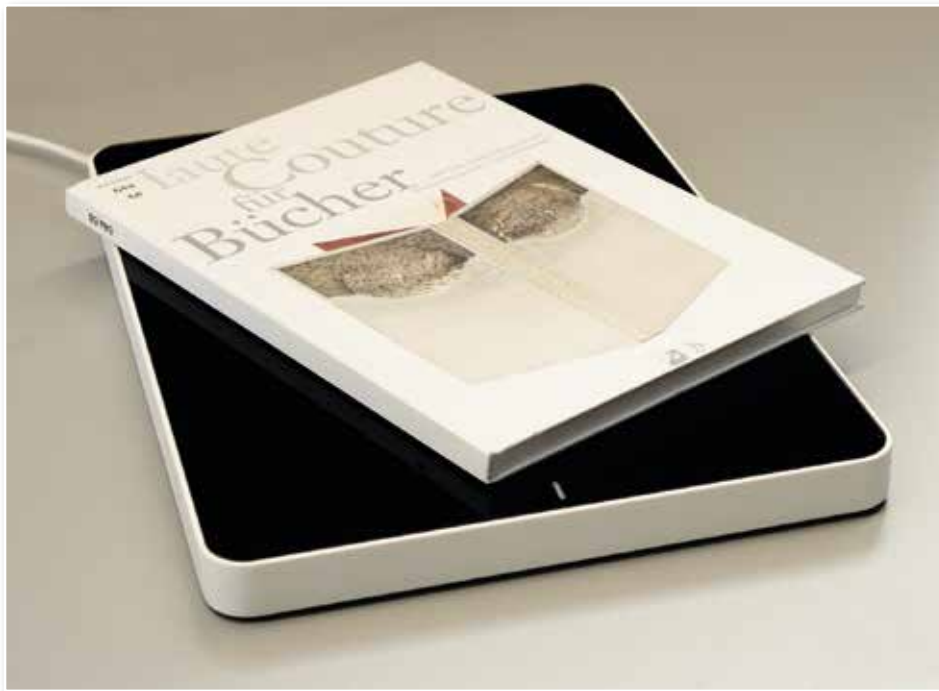
Abb. 2: RFID-Antenne mit integrierter Leseelektronik
