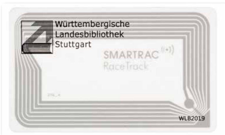
Abb. 1: RFID-Etikett, fotografiert als Durchlichtaufnahme
