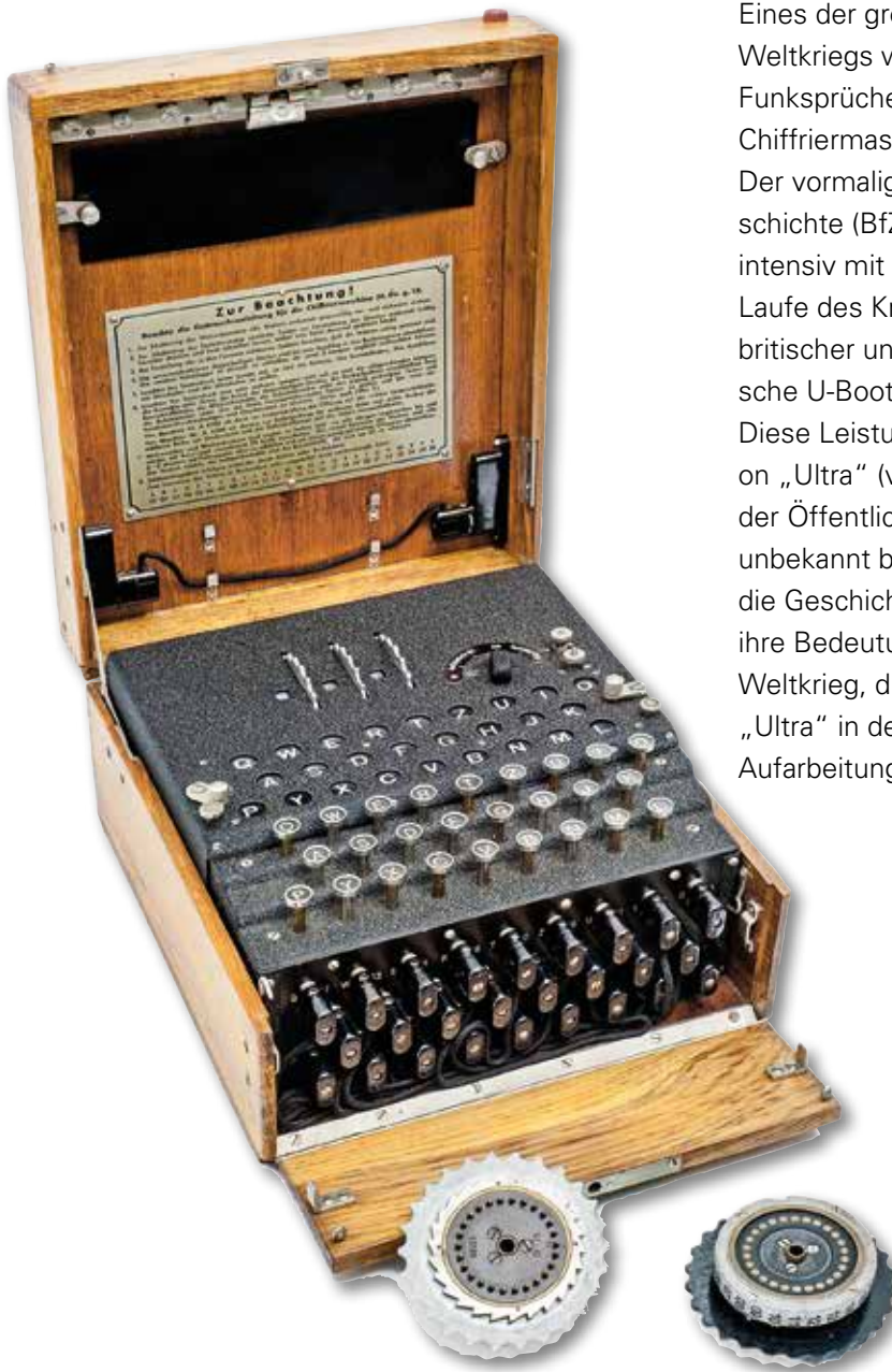
Abb. 1: Enigma mit Austauschwalzen (Foto: WLB / Larissa Arlt)
